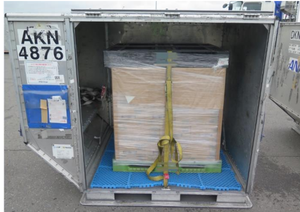
11(イチイチ)型と呼ばれるパレットが LD3 コンテナに収まる様子
