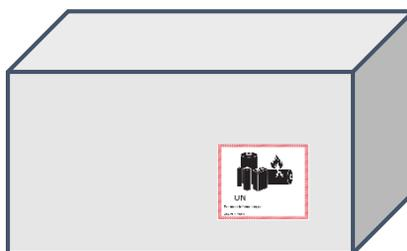
■ 梱包例3【Section II (組電池が2個以下で、運送状1件あたり、当該包装物の個数が2個を超えない場合)】
